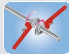
**5.** Com a conexão posicionada no tubo, aperte a porca manualmente com o maior nº de voltas possível no local da montagem. Em seguida aperte a porca com a chave no tamanho apropriado, conforme a tabela 3.
