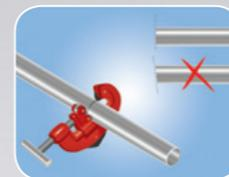
**1.** Cortar o tubo na medida pretendida, perpendicular ao eixo. Os tubos de aço que podem ser utilizados com as conexões TUPYPRES® devem atender às especificações conforme a tabela 1.
