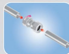
**4.** Introduzir o tubo na conexão. No cotovelo e no tê, há limitadores internos onde o tubo deve ser encostado. A conexão luva, que é passante, não possui limitador interno. Neste caso, marque o comprimento do tubo conforme o diâmetro da tabela 2 e introduza na conexão até a marca.
