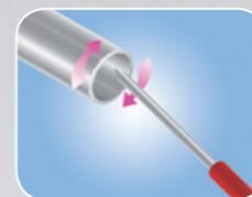
**2.** Escariar e remover rebarbas da borda do tubo, com lima e/ou lixa. Rebarbas no tubo podem danificar a borracha de vedação. A superfície do tubo a encaixar deverá estar limpa, sem resíduos de oxidação, cimento, graxa, óleo, etc. Não aplique lubrificante na conexão, nem no tubo.
